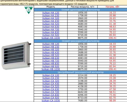
Vulkan-HE/CE - агрегаты воздушного отопления с 1-о или 3-х скоростными осевыми и центробежными вентиляторами с
